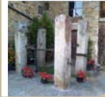
Les cages pour ferrer le bétail se composaient de quatre piliers de granit, avec des supports en bois, des laisses pour tenir l'animal et des poulies pour le soulever. Ces cages se trouvaient dans chaque village et étaient à usage public.
